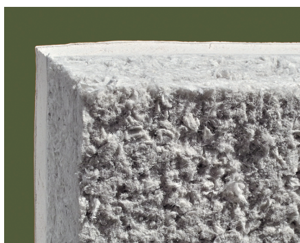
Próbka EKO FIBRU naniesiona metodą mokrą na płytę gips-karton (ze źródeł amerykańskich)
